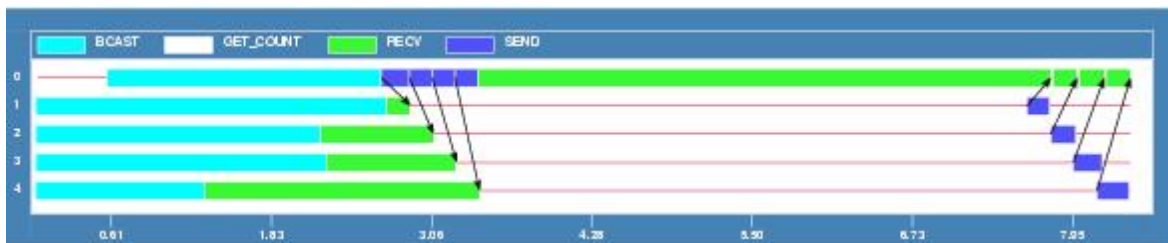
Figure 25 : Chronogramme d'un algorithme utilisant la fonction diffusion de MPICH
